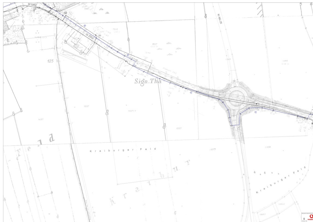
Abbildung: Lageplan der vorhandenen Telekommunikationsanlagen; Vodafone GmbH.
