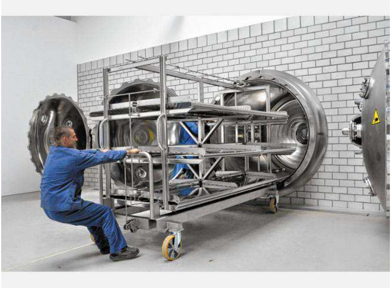
Die neue Papersave swiss-Anlage der Nitrochemie in **Aschau-Werk**: Das Bild zeigt die drei Vakuumkammern, in die Bücher mit Hilfe dieses Wagens hineingefahren werden, um das Papier zu entsäuern und Bücher und Dokumente damit für die Nachwelt zu erhalten. Foto hsc
